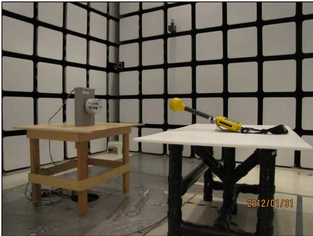
Figure 4- Mesures d'un compteur domestique monté sur un boîtier électrique typique
