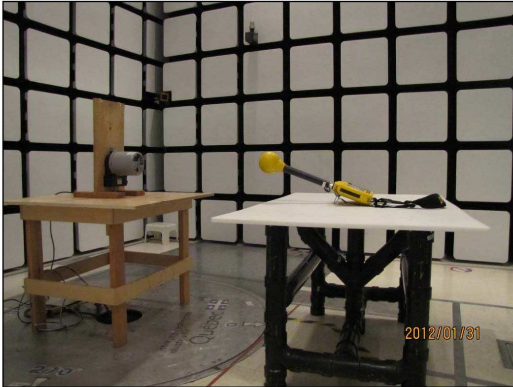
Figure 3- Mesures d'un compteur CII sans panneau électrique de montage
