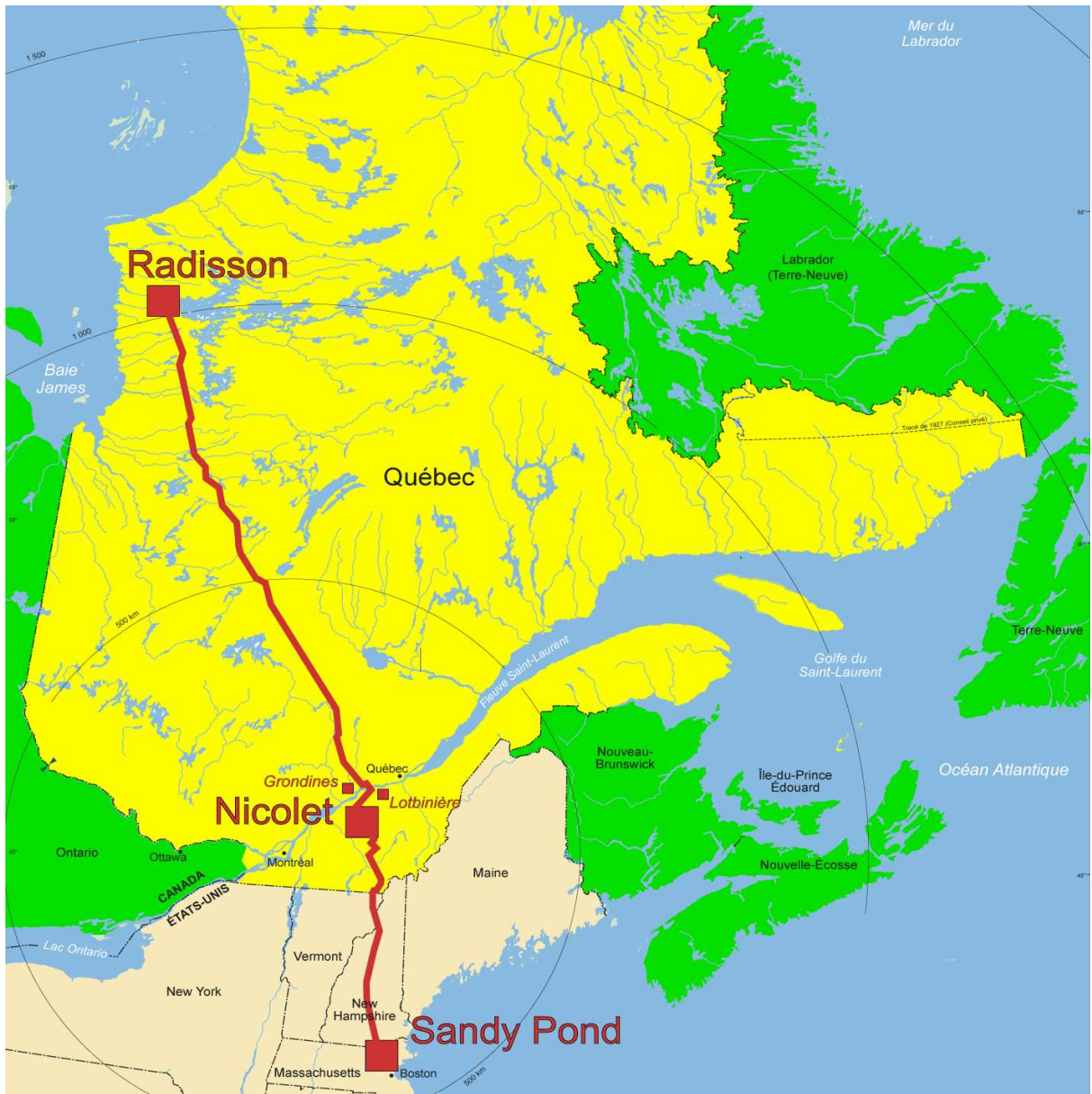
Figure 1 Réseau multiterminal à courant continu
