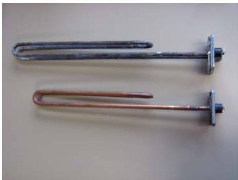
Figure 23 : Élément de 800 Watts (en haut) utilisé durant deux (2) ans versus un élément neuf de 3 800 Watts en bas
