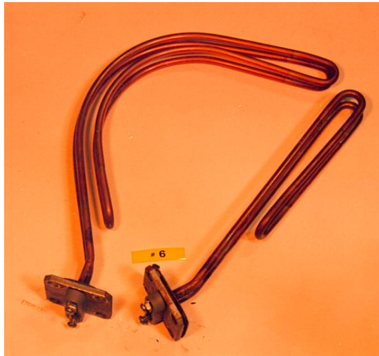
Figure A5-7 : Éléments électriques installés à l'époque en usine dans les années 1990 dans le chauffe-eau du parc de location d'Hydro-Québec.
