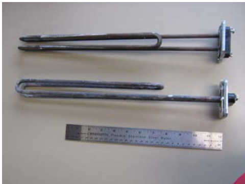
Figure 22 : Élément de 800 Watts utilisé durant deux (2) ans vu sous deux angles
